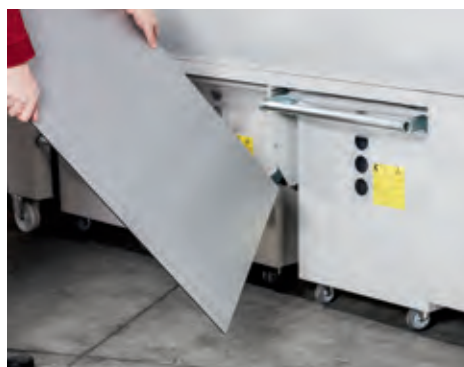
Staubschott wieder entfernen
