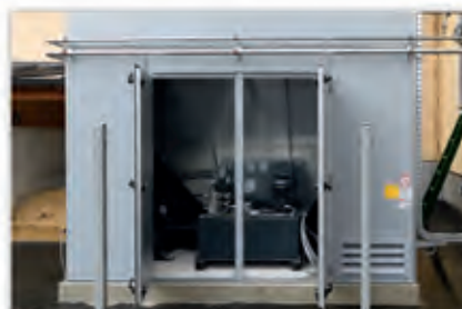
Brikettierpresse in Filtergehäuse integriert
