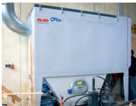
AL-KO Power-Jet Reinluftentstauber mit Brikettierpresse (MA 48)
